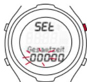
Taste TOGGLE (+) fünfmal drücken, bis 5 angezeigt wird.
