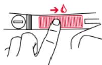
Den Gurt frontseitig leicht von der Haut abheben. Gerippte Zonen (Elektroden) auf der Rückseite des Senders mit Speichel oder mit Wasser befeuchten.
