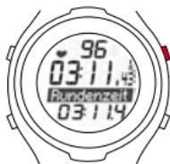
5. Wenn Sie das Training beenden wollen, drücken Sie die Taste START/STOP. Die Stoppuhr steht. Um die Werte auf Null zurückzusetzen, drücken Sie die Taste START/STOP lang. Um den Trainingsmodus zu verlassen, halten Sie die Taste TOGGLE (-) lang gedrückt.
