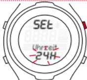
Taste START/STOP drücken. „24H“ wird angezeigt und blinkt. Mit der Taste TOGGLE (-) oder TOGGLE (+) wählen Sie zwischen einer 12-Stunden- oder 24-Stundenanzeige.
