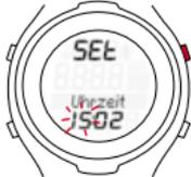
Taste START/STOP drücken. Die Uhrzeit wird angezeigt. Die Stundeneingabe blinkt.
