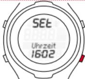
Taste TOGGLE (+) drücken. Eine Stunde wird hochgezählt. Mit der Taste TOGGLE (-) würde die Anzeige um eine Stunde runtergezählt.
