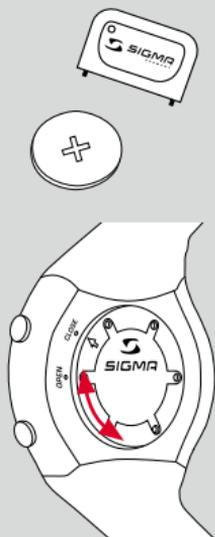
Im Puls Computer und im Sender wird die Batterie CR 2032 (Art.-Nr. 00342) verwendet.
