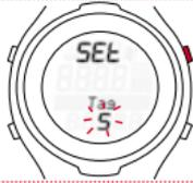
Taste START/STOP drücken. Ein Datumsformat wird angezeigt. Mit der Taste TOGGLE (-) oder TOGGLE (+) wählen Sie das gewünschte Datumsformat aus.
