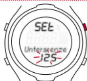
Taste START/STOP drücken. „Untergrenze“ wird angezeigt. Der eingetragene Wert blinkt.
